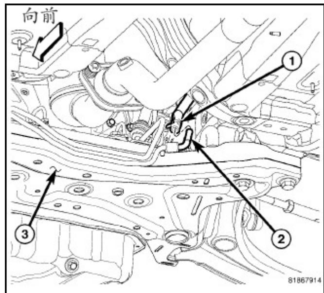
8. 安装泵高压端口(5)处的高压软管(3)。拧紧管螺母(1)至32 N·m(24 ft. lbs.)。
