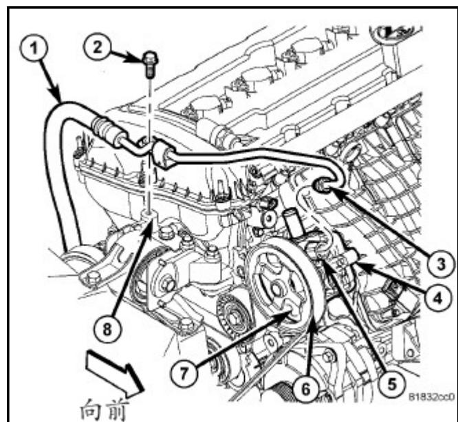
10. 除了带有四轮驱动的2.4L发动机的全部-将压力软管导向卡箍(2)放在排气管上并安装固定螺栓(1)。将螺栓拧紧至9 N·m(80 in. lbs.)。
