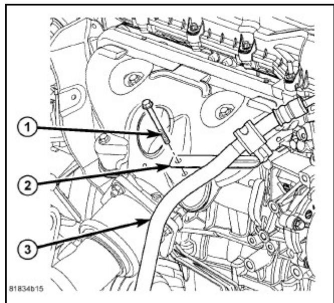
11. 带有四轮驱动的2.4L发动机-将压力软管导向卡箍(2)放在排气管上并安装固定螺栓(1)。将螺栓拧紧至9 N·m(80 in. lbs.)。
