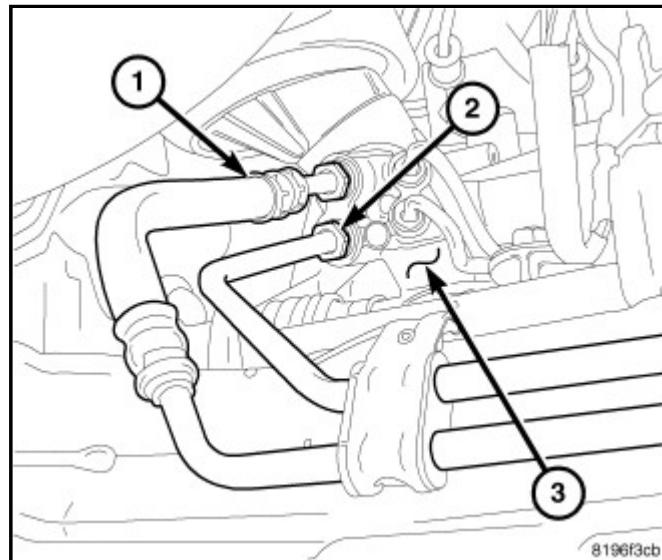
6. 安装回流管(2)处的回流软管(1)。
